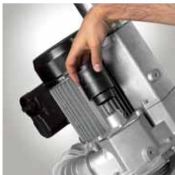
La válvula limitadora del vacío permite trabajar en total seguridad
