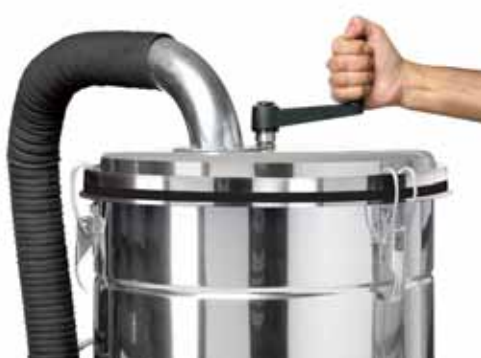
El cómodo pomo sacudidor del filtro, gracias a la larga palanca, facilita la limpieza del aparato de filtración
