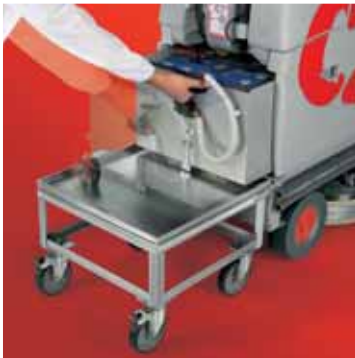
El módulo de las baterías se desliza automáticamente desde la máquina, simplemente tirando de una manija
